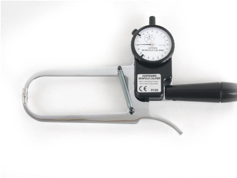
**Plicómetro para valoración nutricional *HARPENDEN*, metálico, incluye estuche y manual. Se considera el estándar de oro que la mayoría de los investigadores utilizan para aplicar las ecuaciones que estiman porcentaje de grasa. Apertura de 80mm precisión de 0.2 mm.**
